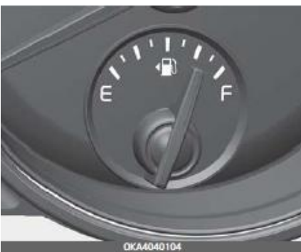
แบบ A : มาตรวัดแบบเข็ม
