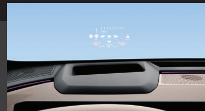
ระบบแสดงผลข้อมูลการขับขี่บนกระจกหน้า Head-Up Display (HUD)
